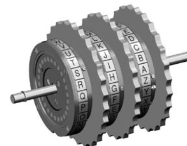
Abb. 37: Walzensatz: Links unten ist eine Übertragskerbe zu erkennen
