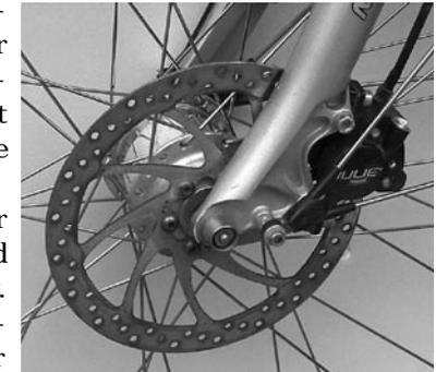
Abb. 179: Nabendynamo mit hydraulischer Scheibenbremse
