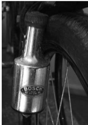
Abb. 178: Seitenläufer-Dynamo von Bosch, um 1950
