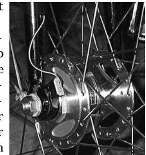
Abb. 180: Nabendynamo mit Verkabelung
