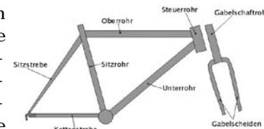
Abb. 64: Darstellung eines Diamantrahmens
