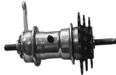
Abb. 107: Eine Rücktrittnabe aus den 50er Jahren mit drei Ritzeln für eine Kettenschaltung
