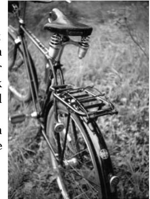
Abb. 3: Opel-Fahrrad von 1935 mit Doppelschleifen-Diamantrahmen
