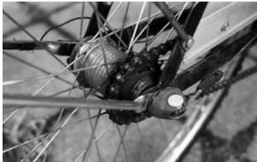
Abb. 162: Eine Nabenschaltung mit Rücktrittbremse
