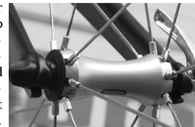
Abb. 168: Fahrradnabe (vorn)
