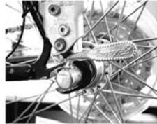
Abb. 108: Schnellspanner festziehen
