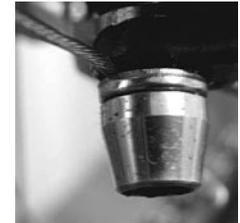
Abb. 111: Klemmschraube kontrollieren
