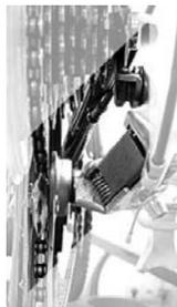
Abb. 119: Parallelogramm
