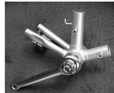
Abb. 88: Glockenlager am Tourenrad mit Kurbel an der falschen Seite
