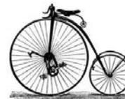
Abb. 10: Das »Känguruh«, ein gemäßigttes Hochrad mit beidseitigem Kettenantrieb am Vorderrad, um ????
