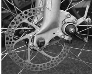
Abb. 152: mechanische Scheibenbremse
