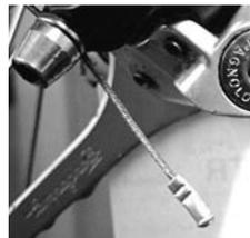
Abb. 110: Schaltzug kontrollieren
