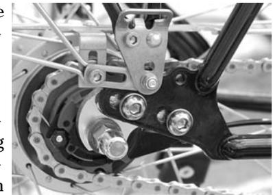
Abb. 74: OEM-Ausfallende für Speedhub 500/14-Nabenschaltungen
