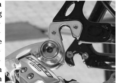
Abb. 73: Ausfallende am Alu-Rennrad mit wechselbaren Schalttauge
