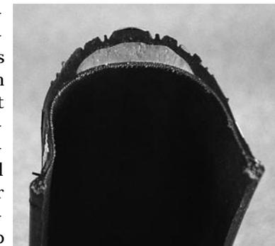
Abb. 174: Spezialkautschuk – Einlage im Fahrradreifen
