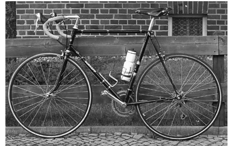
Abb. 48: Bahnrad von Dürkopp Bj. 1952, umgebaut zum Straßen-Rennrad
