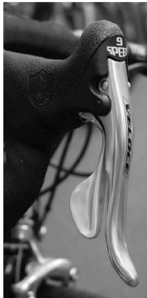
Abb. 57: Bremsschaltgriff
