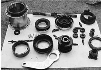
Abb. 128: Eine zerlegte Dreigangnabe mit Rücktrittbremse
