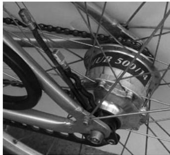
Abb. 150: Speedhub 500/14 im eingebauten Zustand
