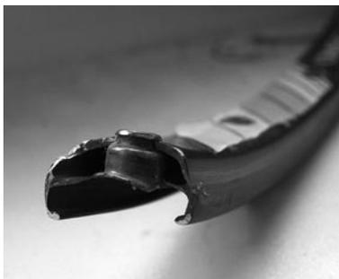
Abb. 167: stabilste Version mit Nappbefestigung innen und außen
