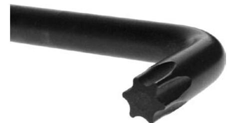
Abb. 213: Torx-Schraubenschlüssel
