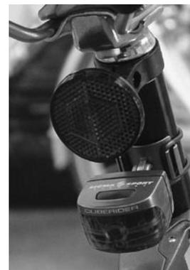
Abb. 58: Batteriebeleuchtung hinten
