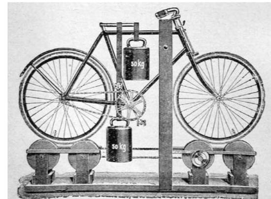
Abb. 13: Voll ausgebildeter Diamantrahmen (Prüfstand der Gebrüder Revoigt).
