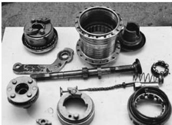
Abb. 129: Eine zerlegte Nabenschaltung (Modell 55)
