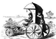
Abb. 5: John Vevers »Reisewagen« von 1769. Der Diener am Heck trieb den Wagen mit Tretkurbeln an, gelenkt wurde vorn.
