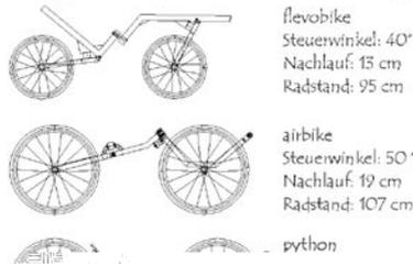
Abb. 39: Rahmengenometrie von Knicklenkern
