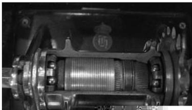
Abb. 163: Komet-Freilauf mit Rücktrittbremse, geschnitten
