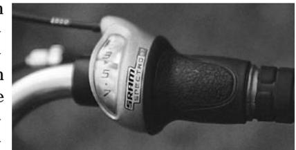
Abb. 102: Drehgriff einer 7-Gang Nabenschaltung
