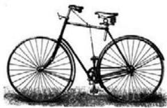
Abb. 1: Niederrad mit Diamantrahmen
