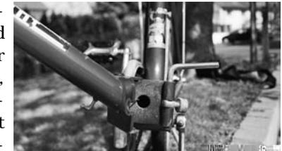
Abb. 38: Scharnier mit senkrechter Achse
