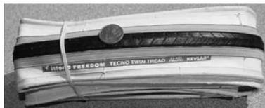
Abb. 173: Mittelbreiter Drahtreifen 622-23 für Rennrad
