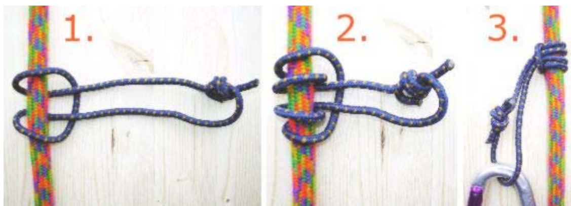
Knüpfen eines Prusikknotens
