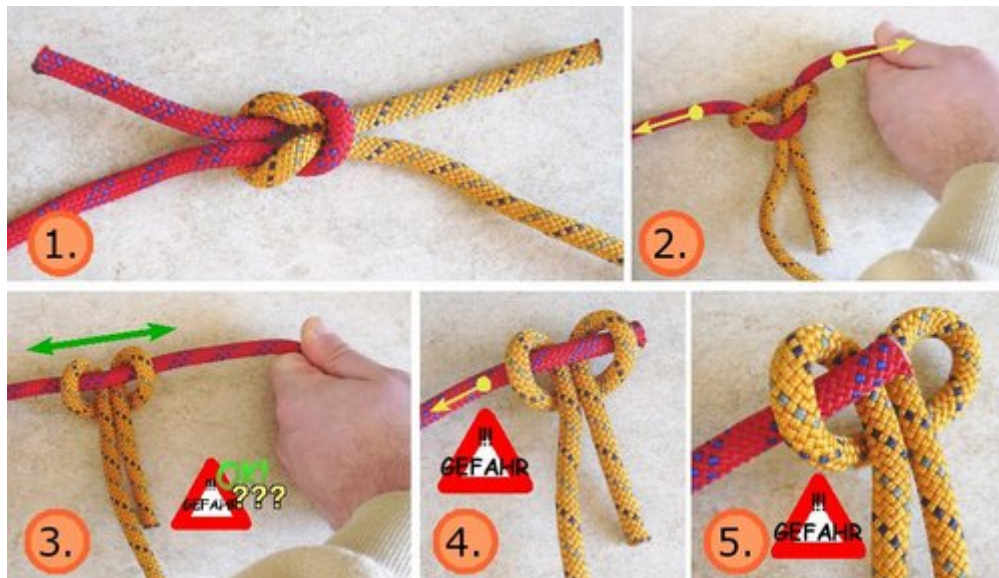
Das Lösen eines Kreuzknotens durch Zugbelastung am Seilende in Gegenrichtung.
