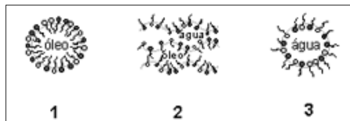
Figura 3-Tipos de microemulsões: a) tipo O/A, b) bicontínua, c) tipo A/O
