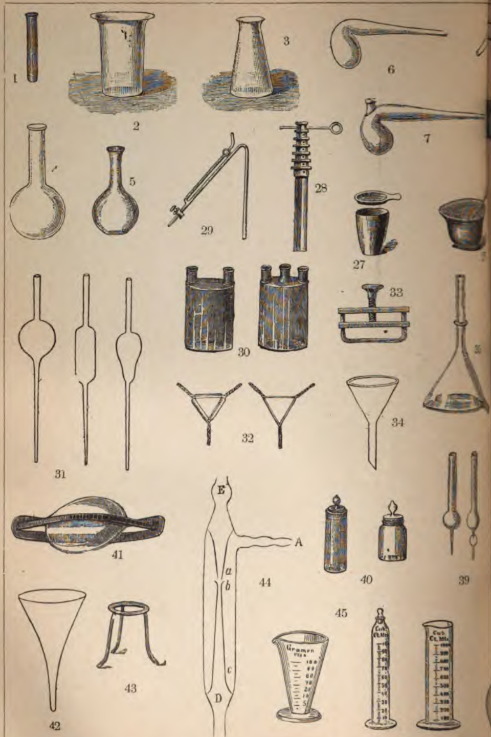
1 Пробирка. 2. Стаканъ. 3. Колба испиточная. 4. Баллонъ. 5. Колба. 6 и 7. Реторты. 8. Аллонжъ. 9. Алатонъ жимъ. 15. Ножъ для точи сверля. 16. Тигельные щипцы. 17. Тройная горьла Бунзена. 18. Насадки для топ 23. Калл-аппараты Гейслера. 24. Ступка фарфоровая. 25. Ступка желъзная. 26. Кристаллизаторъ. 27. Платиновый Воронка съ угломъ 60°. 35. Воронка В. Мейера. 36. Щетка для чисти пробирокъ. 38. Скатанка Дрейселя. 40. Ва сосъ Альверсия. 45 и 46. Измърительные сосуды. 47. Штативъ для бюретокъ
