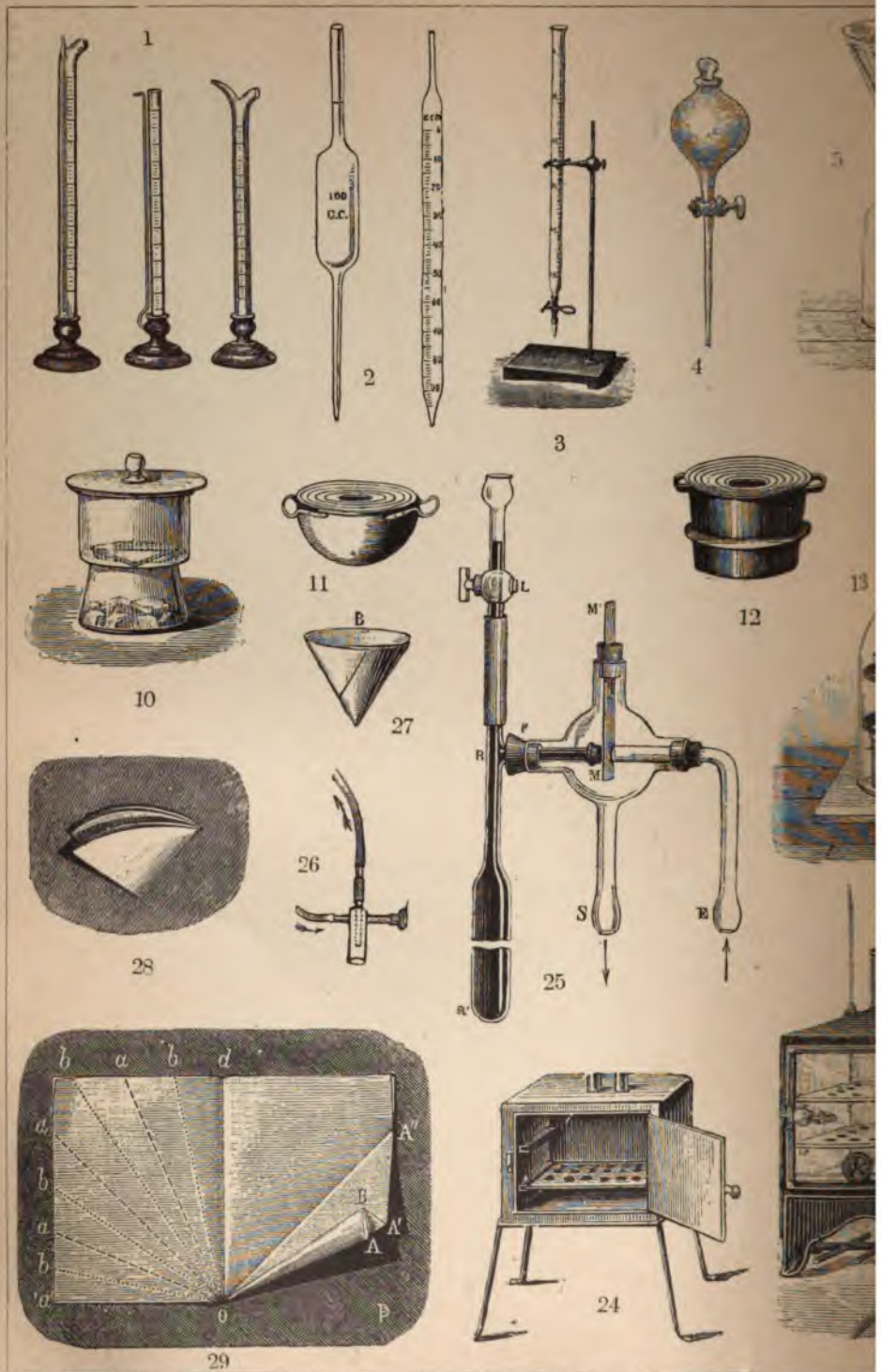
1 и 3. Бюретки. 2. Градуированные пипетки. 4. Разделятельная воронка. 5. Фильтрование через плоский фильтр Рейхарта. 10, 13, 14 и 22. Эвасиаторы. 11, 12 и 16. Водяные бани. 17. Спиральный холодильник. 24. Воздушная баня. 25. Регулятор Шлезинга. 26. Водяной регулятор.
