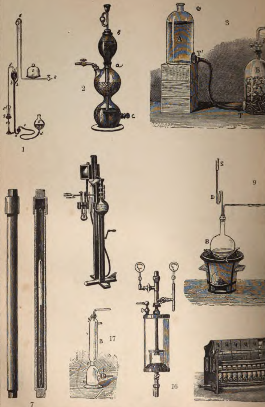
1. Ртутный насос Менделѣева. 2. Аппаратъ Кипля. 3. Аппаратъ С. К. Девиля. 4. Экстрактъ Соксета. 5. Ртутный насос Гейслера. 6. Ртутный насос Гейслера. 7. Ртутный насос Гейслера. 8. Ртутный насос Гейслера. 9. Ртутный насос Гейслера. 10. Ртутный насос Гейслера. 11. Ртутный насос Гейслера. 12. Ртутный насос Гейслера. 13. Ртутный насос Гейслера. 14. Ртутный насос Гейслера. 15. Ртутный насос Гейслера. 16. Ртутный насос Гейслера. 17. Ртутный насос Гейслера.
