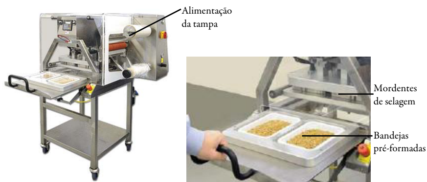
Figura 5.3 - Exemplo de equipamento semi-automático operando com molde de duas bandejas ( http://www.arpachefestus.com/Athena.html )
